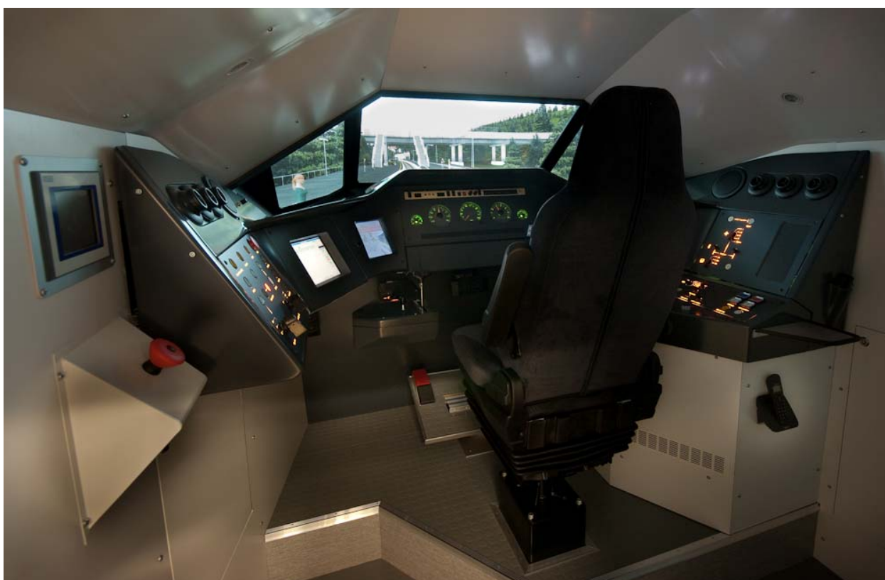
Tågsimulatoren med visionsystem som visar datorgrafik av järnvägsspåret.
